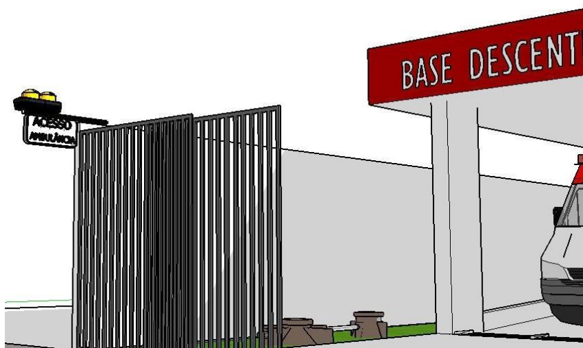
Figura 9 – Sinalização semafórica no acesso de ambulância. Fonte: Equipe CGUE/DAHU/SAS/MS
